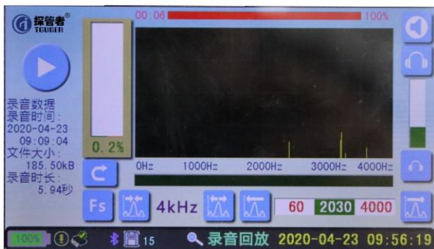
◇复听录音的界面与搜索模式的界面类似，只是没有“增益状态”框，而多了个“放音进度”框。放音进度”框在放音时显示放音的进度，该框左面的数字是该录音文件的录音时长，右面的是放音百分比。按下播放键，即可开始播放录音。播放时播放键将变成暂停键。同时返回键改变为停止播放键。复听录音的界面也可以调节已经录音的滤波带的宽度和滤波带中心频率点，以及场景的选择；
