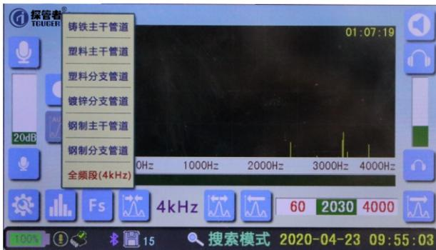
◇ 搜索模式与探测模式。“搜索模式”主要用于管道漏水声或激励声源的检测。“探测模式”与发射声源配合，可以方便的定位管道的位置；
